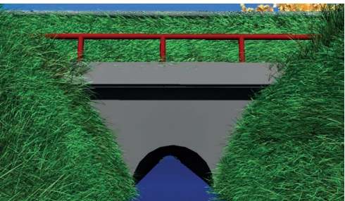
3. Celkový pohled na trubní propustek.
